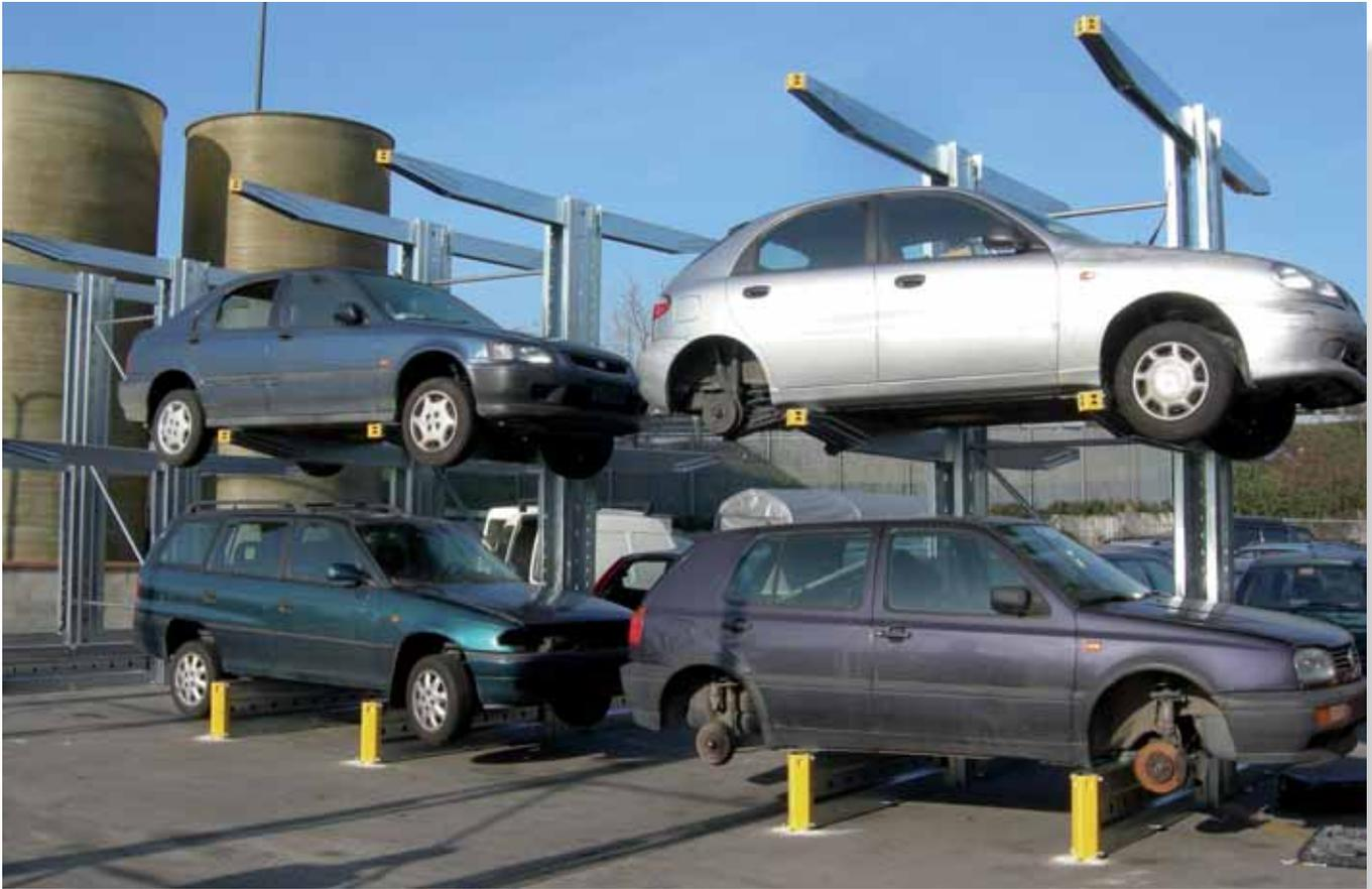
Questa robusta scaffalatura è stata creata per risolvere problemi di stoccaggio per materiali di notevoli dimensioni quali tavole, pannelli, barre, lamiere, tubi e quant'altro. La modularità in altezza e in profondità permette di adattare la scaffalatura ad ogni spazio, secondo qualsiasi esigenza. Coperto da brevetto internazionale a salvaguardia della sua unicità è realizzato in versione monofronte e bifronte, confinitura zincata sendzimir.
