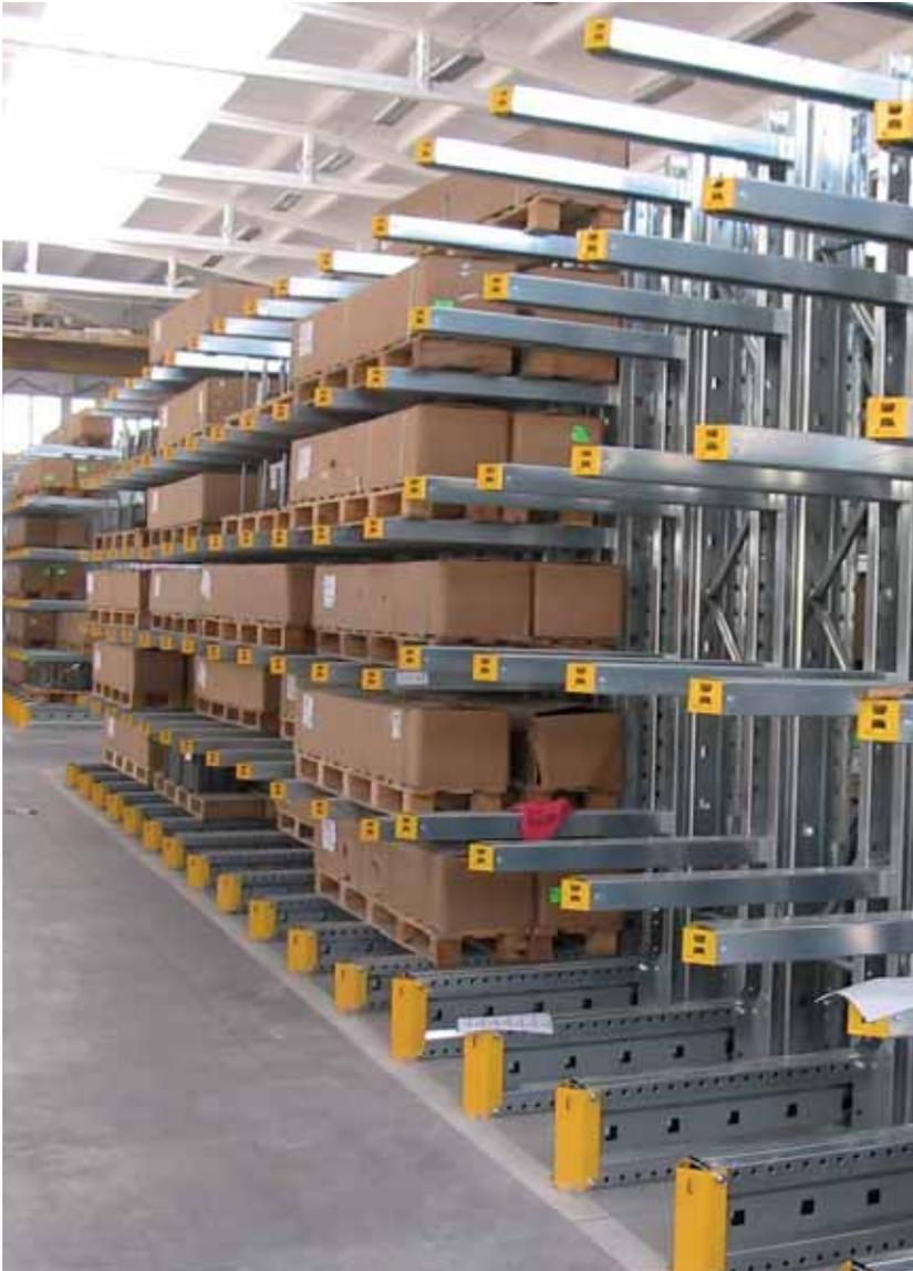
La scaffalatura Cantil Sigma è il risultato di una lunga e attenta ricerca e di uno studio approfondito eseguito da tecnici e ingegneri strutturalisti, imponendo una totale assenza di saldature. Le scrupolose prove con carichi esasperati effettuate nei più avanzati laboratori, mettono in luce le qualità del prodotto, nato per durare nel tempo.
